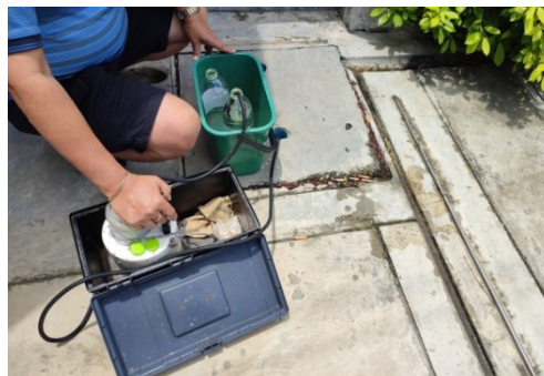
ภาพที่ 10-9 ฝाप่ตรวจสอบคุณภาพน้ำทิ้งเป็นฝาคอนกรีต และเก็บตัวอย่างตรวจสอบคุณภาพน้ำทิ้งด้วยวิธี Grab Sampling ทุกเดือน
